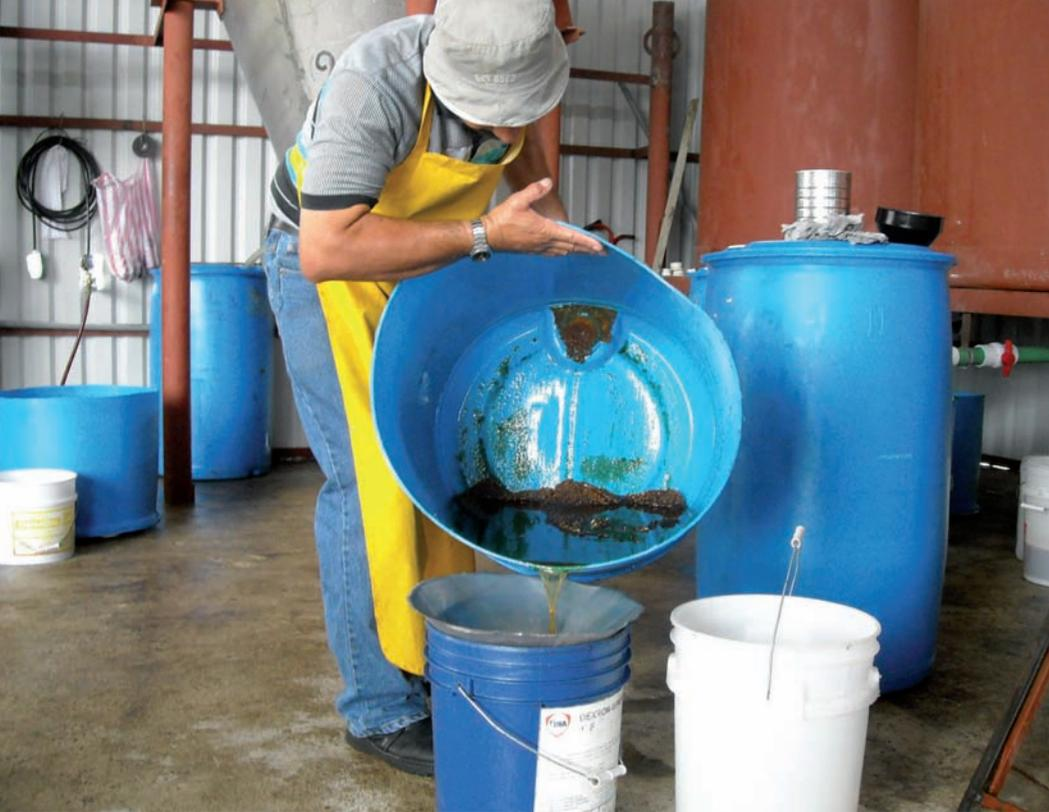
Preparando biodiesel a partir de desecho de aceite de cocina para uso en maquinaria agrícola
